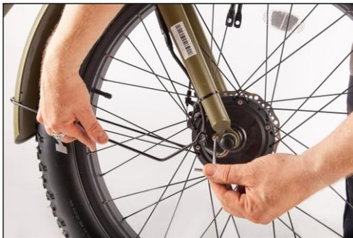
Ослабьте при помощи шестигранников крепление выноса руля, разверните его и установите в положение, параллельное продольной оси велогибрида.
